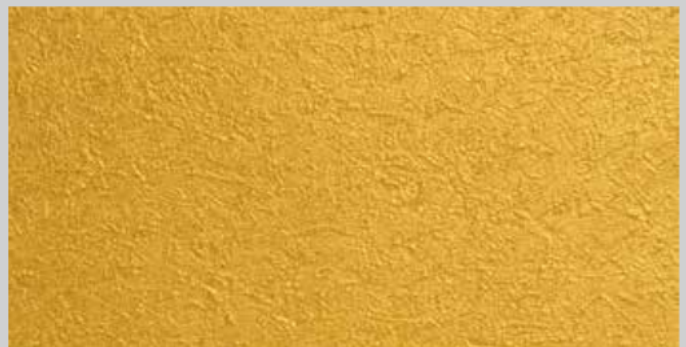
Tamponeren: 1x MultiStruktur mittel, 2x EffektGrund, 2x CapaGold
